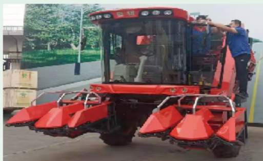
高地隙跨带玉米收获机 (可跨大豆带收2带玉米)
